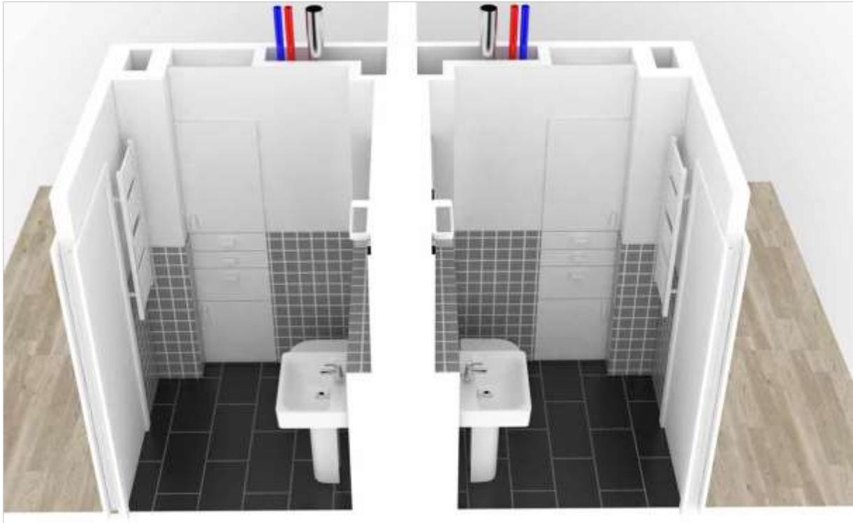
Abbildung 102 Schema des vorgefertigten Bad-Blocks [HOWOGE-JAHN 2017]
