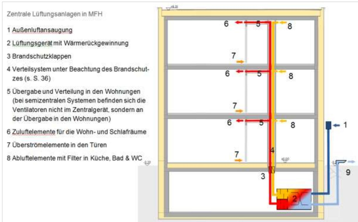
Abbildung 49 Schema einer zentralen Komfortlüftungsanlage mit Wärmerückgewinnung (MFH)
